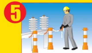
Delimitar y señalizar la zona de trabajo
